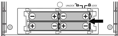
1. Öffne das Batteriefach, indem du die Abdeckung in Pfeilrichtung schiebst.
