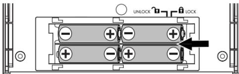
1. Öffne das Batteriefach, indem du die Abdeckung in Pfeilrichtung schiebst.
