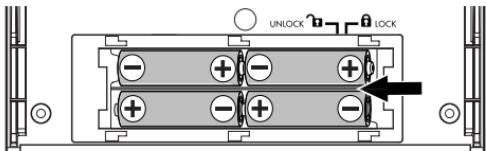
1. Pour ouvrir le logement des piles, appuyez légèrement sur l'onglet situé près de la flèche et soulevez le couvercle. Installez quatre piles alcalines (vendues séparément) en respectant la polarité et refermez le couvercle.
