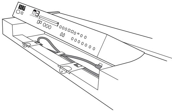
3. Lösen Sie die vier Schrauben der Halterungsleiste „A“, welche das Modul in der Tastatureinheit verankert, mit einem Kreuzschlitzschraubenzieher (+).
