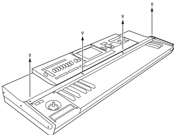
4. Relevez légèrement le module puis soulevez-le des deux mains afin de retirer le module et la barre de retenue "A" de l'ensemble clavier.
