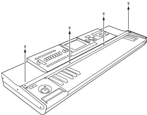
4. Heben Sie das Modul leicht an und ziehen Sie es anschließend mit beiden Händen hoch. Dabei löst sich auch die Halterungsleiste „A“ von der Tastatureinheit.
