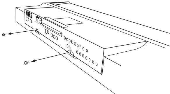
2. Soulevez le module d'une main et débranchez le câble (la fiche en "L") connecté à la prise TO KYBD en face inférieure du module puis abaissez doucement le module.
