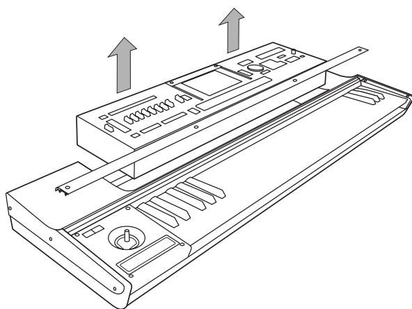
5. Rattachez la barre de retenue "A" avec les vis retirées à l'étape 3. Vous êtes sûr ainsi de conserver les vis et la barre de retenue "A" pour un usage ultérieur.
