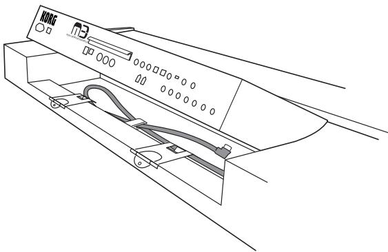
3. Utilisez un tournevis cruciforme pour dévissez les quatre vis de la barre de retenue "A" maintenant le module à l'ensemble clavier.
