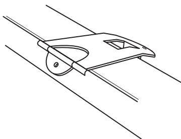
2. Halten Sie das Modul mit beiden Händen fest, während Sie es wie nachstehend gezeigt in die Tastatureinheit gleiten lassen.
